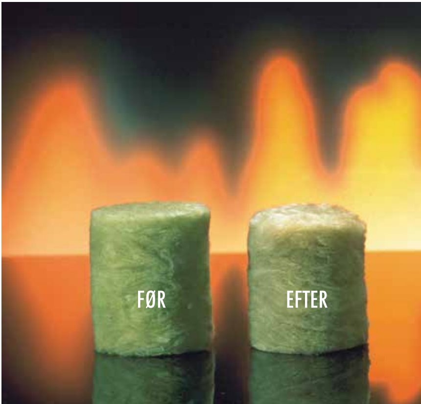
Paroc® Stenuld kan modstå meget høje temperaturer. Billedet viser et eksempel på PAROC® Stenuld før og efter en brandtest iht. EN ISO 1182, hvor testgenstanden udsættes for en temperatur på 750° C.
