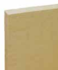
PAROC HVAC SLAB N1 Ubrændbar plade af stenuld med yderlag af stapelfiber, tilpasset til kondens, lyd- og varmeisolering.
