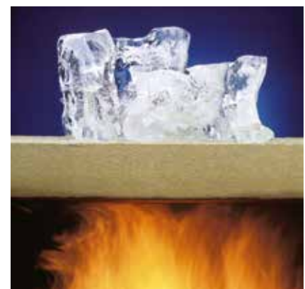
Stenuld beholder sine egenskaber ved så høje temperaturer som 1000 °C og udgør derfor en god passiv brandsikring.
